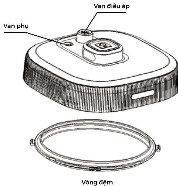
3. Vệ sinh van điều áp: Kéo van lên trên và rửa sạch bằng nước; sau đó lắp lại vào nồi.
